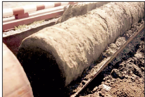
Рис. 2. Извлеченный ствол грунтоцементной композиции сваи
