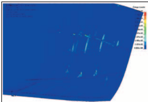
Рис. 1. Характер повреждений бортового перекрытия судна в поле пластических деформаций (движение судна полным ходом в крупнобитых льдах толщиной 1 м)
